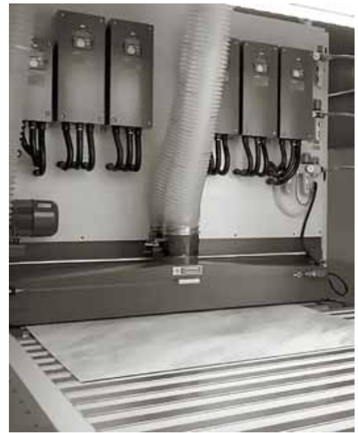
Anlagenauslauf mit „Hot Coating“-Platte in Hochglanz
